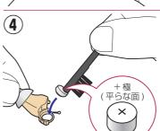
お掃除ブラシの先端(磁石) を使って、電池を入れる
