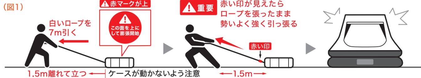
ガスが注入されると、シューツという音がし、15~20秒でケースが自動的に開き、透明のビニール広巾バンドで覆われた本体がケースの中から出てきます。本体が膨張をつけ、ビニールカバーが破れますが、もし本体がケースから出てきてすぐにビニールカバーが破れなかった時は、ただちに手でビニールカバーを破り膨張動作の手助けをして下さい。2分程でシューツという音がしなくなったら、ガスが全て注入され、搭乗できるようになりますが、もしふくらみが充分でない場合は、いかだ室内にある3ヶ所の空気注入口から、それぞれの気室(カノピー:天蓋を支える支柱気室・いかだ本体の上部気室・下部気室)へ備品の空気ポンプで空気を注入します。使用が長期間になった時も、気室の空気は自然減少しますから、適宜空気を補充して下さい。又温度が下がると、いかだの素材が収縮し、わずかながら空気が減少しますから、空気ポンプで、空気を注入して下さい。
