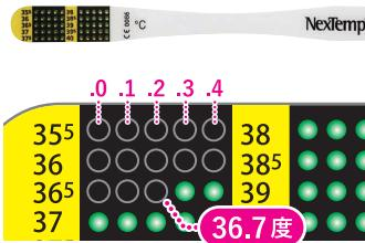
米国製。水銀・ガラス・電池不使用で安全。袋から出し、舌下1分又は腋下3分で測定(直腸温測定不可)。液晶画面の●が●に変化し、最も高い温度の位置の●が体温。下図は36.7°Cを表示。複数人で使用する場合は、毎回消毒液等で洗浄。高温にならない清潔な環境で保管。(ポーチ入り)
