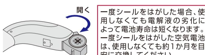
一度シールをはがした場合、使用しなくても電解液の劣化によって電池寿命は短くなります。
