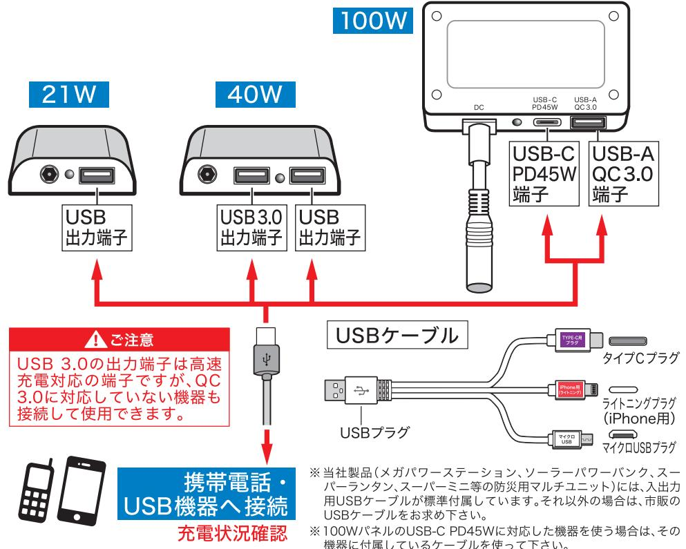
※当社製品(メガパワーステーション、ソーラーパワーバンク、スーパーランタン、スーパーミニ等の防災用マルチユニット)には、入出力用USBケーブルが標準付属しています。それ以外の場合は、市販のUSBケーブルをお求め下さい。
