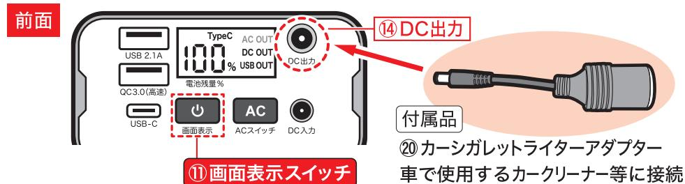
**!!ご注意** この⑭のDC出力の電圧は10ページの「仕様」に記載の通り12V-16.8Vです。この電圧は内蔵電池の残量によって電圧が変化しますから、接続する車用小型機器の動作電圧の仕様によっては動作しない場合もあります。車用小型機器をお使いの場合はその機器の仕様書をお確かめ下さい。
