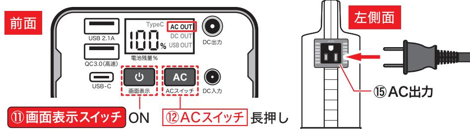
※ 小型家電を使い終わった後は、必ず⑫AC電源スイッチを押して⑦[AC OUT]が消えたことを確認して下さい。切らないでおくと、電池が消耗します。
