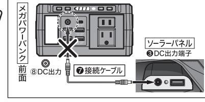
曇りの日や夕方等、太陽光の照度(強さ)が弱いと、「メガパワーバンク」の充電に必要な電力量に満たないため「メガパワーバンク」が充電状態にならず、電池残量表示が消灯したり、早い点滅状態になります。ソーラーパネルによる充電は、十分な太陽光のある環境下で行って下さい。
