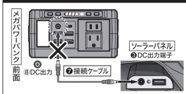
曇りの日や夕方等、太陽光の照度(強さ)が弱いと、ソーラーパネルの出力が不十分となり、「メガパワーバンク」の充電に必要な電力量に満たないため「メガパワーバンク」が充電状態にならず、電池残量表示が消灯したり、早い点滅状態になります。ソーラーパネルによる充電は、十分な太陽光のある環境下で行って下さい。
