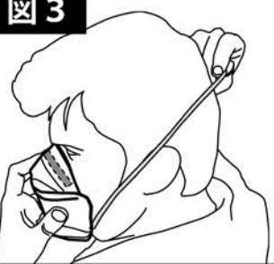
片手でマスクを持ち、鼻と口に当て、残った手でまず下部のゴムバンドを頭の上から通し、首筋に引っかける。次に上部のゴムバンドを頭の後方に引っ張りながら、後頭部に引っかけ、マスクを固定する。
