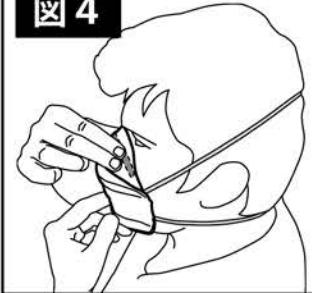
上下のバンドの位置を固定させてから、マスクの位置を調整し、鼻の部分を指で押して、顔に密着させる。
